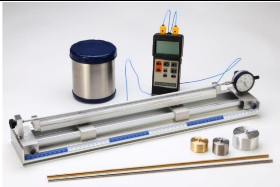
P-27 金屬比熱、線膨脹與電熱功當量
